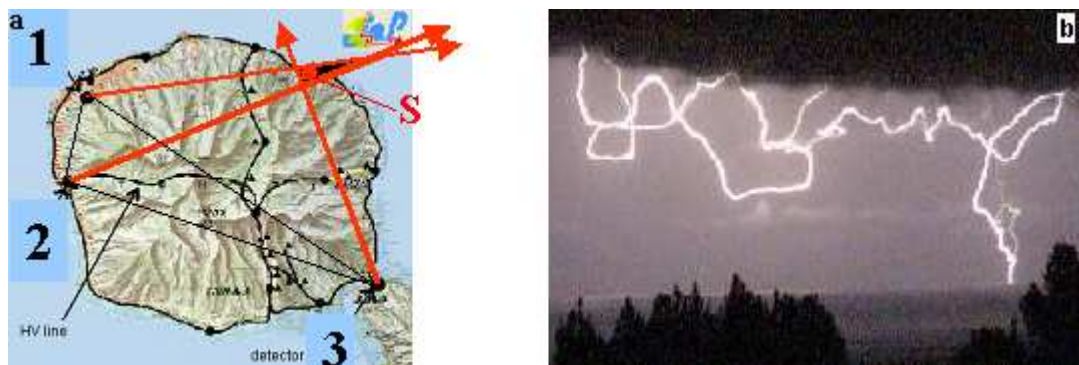
Figure 8 : a) Réseau LIFT; emplacement des 3 détecteurs Boltek; principe de la triangulation et définition de la surface S b) Coup nuage sol avec une tortuosité particulièrement développée (Christian Durocher, Tahiti)
